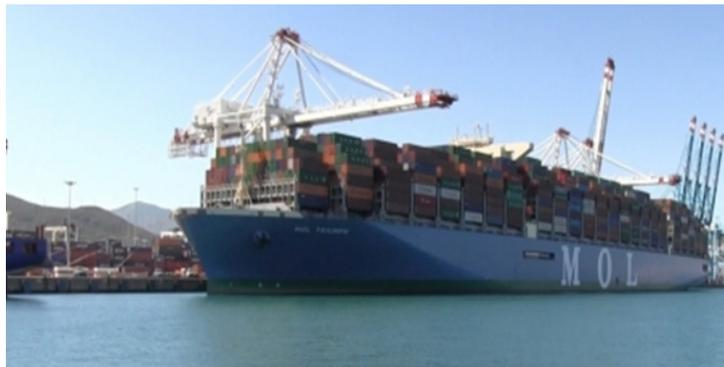
D'une capacité de 20 170 EVP (Equivalent vingt Pieds), une longueur de 400 mètres et une largeur de 58,8 m. Le navire a déchargé lors de son passage au port Tanger Med un volume équivalent à 760 EVP.
